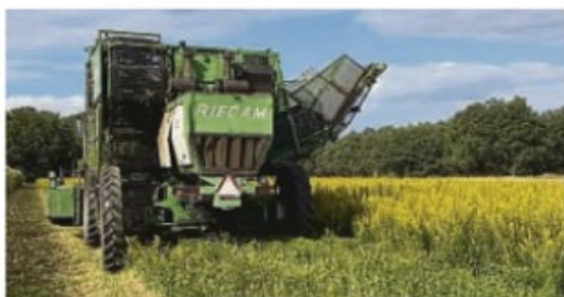
Mit einem Petersilienmäher werden die Blütenstände geerntet. Sie dürfen nicht mit Erde verunreinigt werden. FOTOS: PRIVAT
